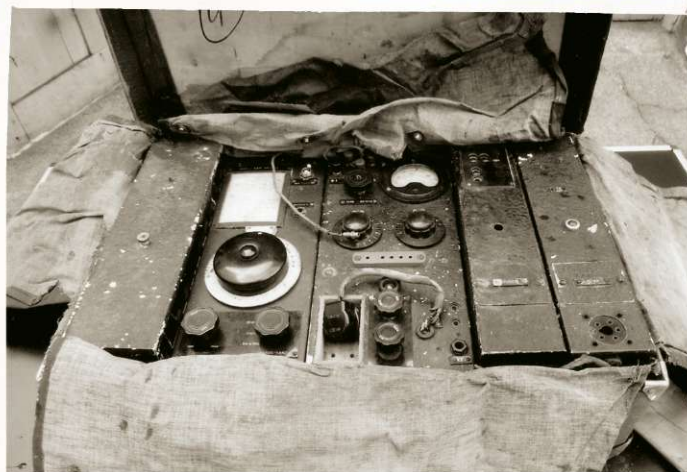
Ce poste-valise modèle B1 conçu par les services secrets britanniques représente un effort vers la miniaturisation, mais il pèse encore 20 kg. Fin 1942, apparaîtra le modèle B2, moitié moins lourd.
