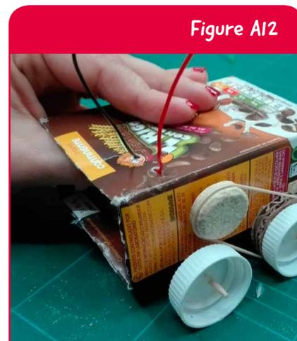
Connectez les fils électriques du moteur à la cellule photovoltaïque (Figure A13), le circuit électrique devrait ressembler à celui que vous avez dessiné dans l'Activité 1, question 9.
