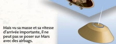
À la place, le rover est suspendu à des câbles sous la nacelle en forme de grue, qui descend doucement avec des rétrofusées pour le déposer sur ses roues au sol. Instead, a sky crane system is used in conjunction with rockets to control its descent. Cables then lower the rover to a soft landing on the surface, wheels down.
