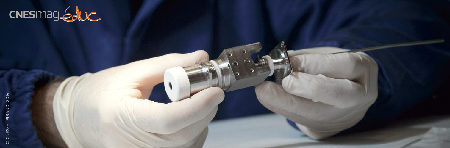
▲▲ Assemblage de la cathode du propulseur PPS@1350. Assembling the cathode of the PPS@1350 thruster.
